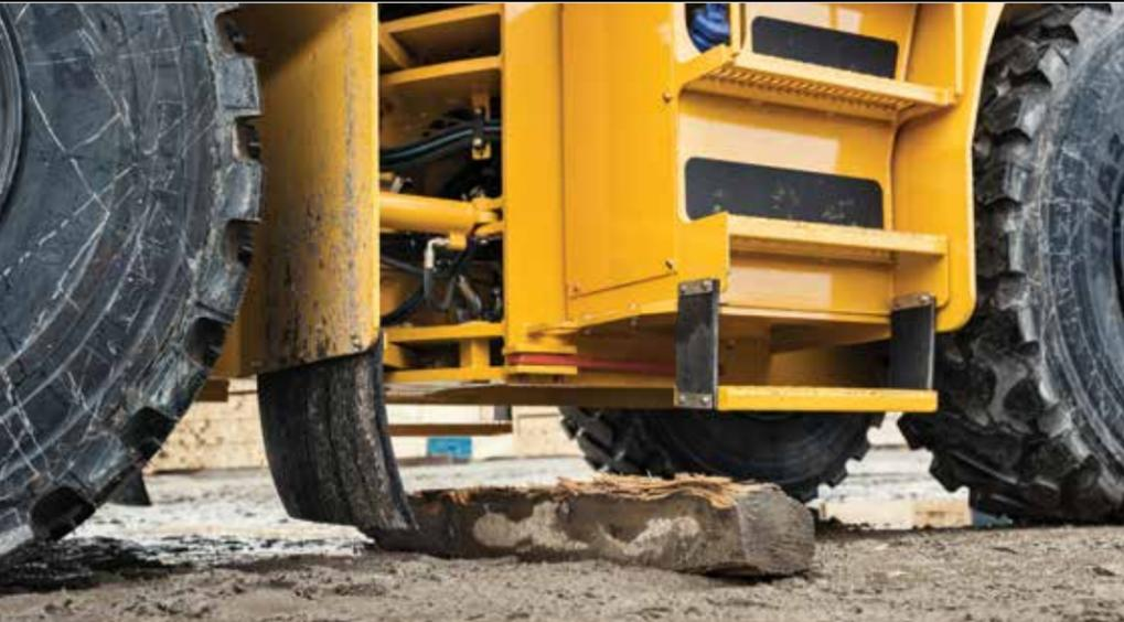
Les chariots élévateurs 4DA20D XRT et 4DA25D XRT avec mât de levage vertical offrent la garde au sol la plus haute de tous ceux actuellement sur le marché.
